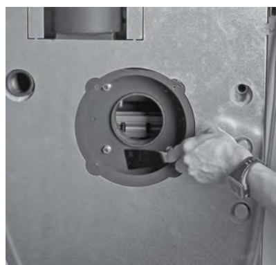
Fig. 38 Gebläsekasten innen reinigen
