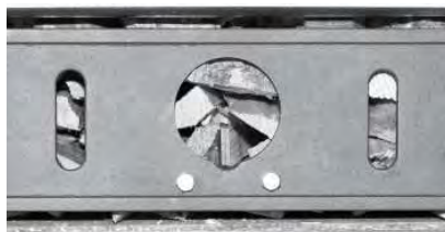
Fig. 20 Richtig eingelegtes Scheitholz vor der Zündöffnung
