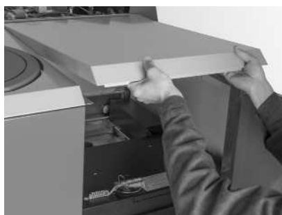
Fig. 68 Deckel nach vorne ziehen und abnehmen
