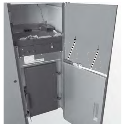
Fig. 28 Reinigungspinsel und Spachtel innen in der Verkleidungstüre
