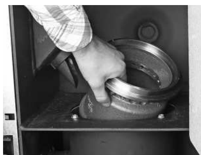
Fig. 57 Konus Unterteil herausheben
