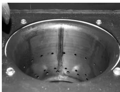
Fig. 63 Sekundärluftlöcher im Brennertopf reinigen
