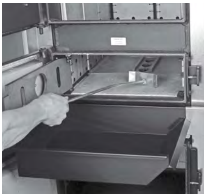
Fig. 16 Aschelade einhängen, Asche entfernen
