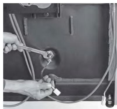
Fig. 45 Lambdasonde abstecken und herausdrehen
