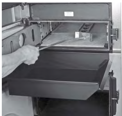
Fig. 32 Aschelade einhängen, Asche entfernen
